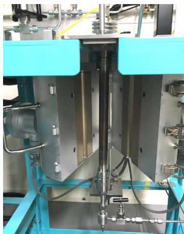
ヒーター加熱の反応管 10MPa、500°C、Alloy276
