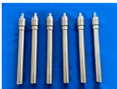
縦長仕様 15MPa、200°C、SUS316 内径 30mm × 長さ 360mm
