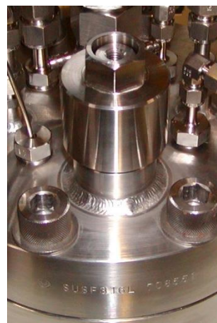
反応容器の仕込み口 6MPa、200°C、SUS316L
