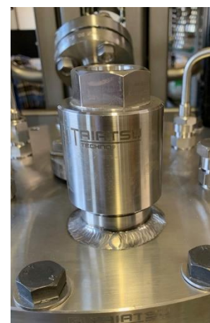
反応容器の仕込み口 6MPa、200°C、SUS316
