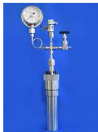
TPR2-VS2-300 圧力計、安全弁付
