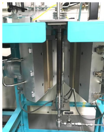
ヒーター加熱の反応管 10MPa、500°C、Alloy276
