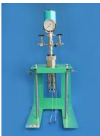
TPR1-VS2-200 攪拌機、ヒーター 圧力計、安全弁付
