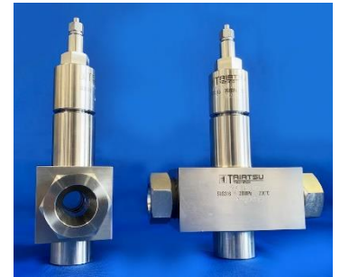
窓付き仕様 20MPa、200°C、SUS316 窓部径 20mm
