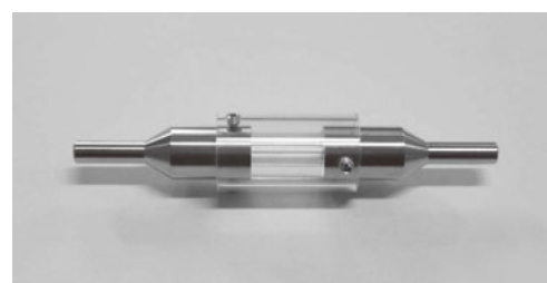
1/4インチ食い込み接手仕様 高圧流体観察セル
